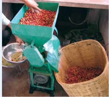
การปอกเปลือกผล cherry ด้วยเครื่องปอกเปลือกกาแฟ
